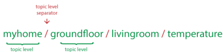
Σχήμα 5.2: Απεικόνιση ενός παραδείγματος που δείχνει τα βασικά στοιχεία ενός MQTT topic [20]
