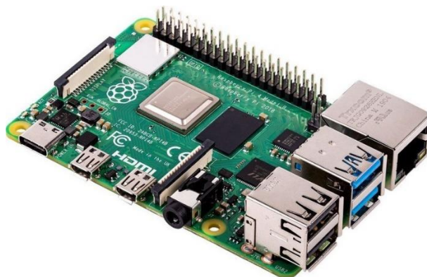
Εικόνα 3.1: Απεικόνιση του Raspberry Pi
