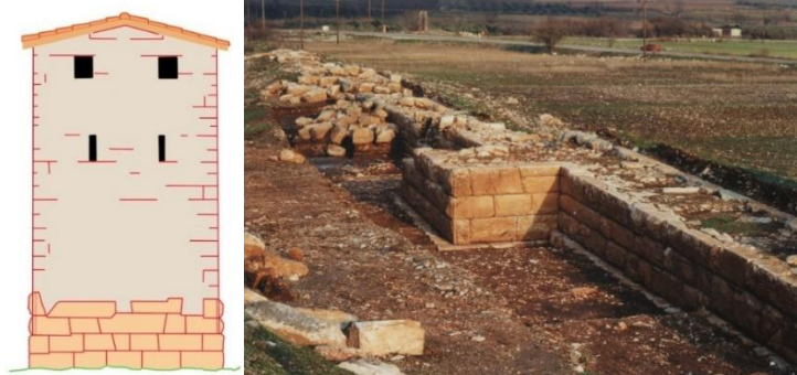
Εικόνα 3.1.2 - Άλος. Αριστερά: Σχεδιαστική αποκατάσταση της πρόσοψης πύργου του βορείου τείχους της Άλου (Reinders et.al. 2014, 37, εικ. 2.10). Δεξιά: Φωτογραφία από την ανασκαφή του τείχους της κάτω πόλης (Reinders et al. 2014, 35, εικ. 2.7).
