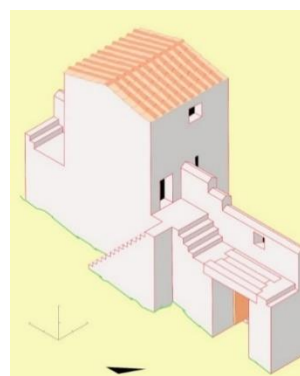
Εικόνα 3.1.6 - Άλος. Ισομετρική ανακατασκευή της πύλης της ακρόπολης (Reinders et al. 2014, 56, εικ. 3.14).
