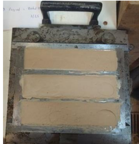
Σχήμα 3.13 Εφαρμογή κονιάματος σε μήτρα
