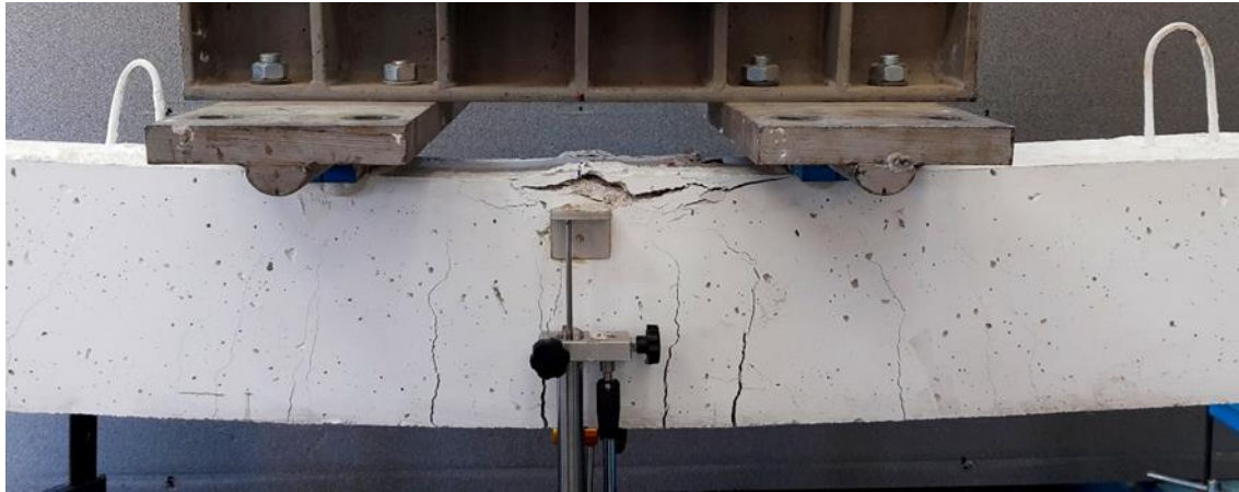
Σχήμα 4.2 Ρηγματώσεις, θραύση και σύνθλιψη σκυροδέματος στη δοκό control
