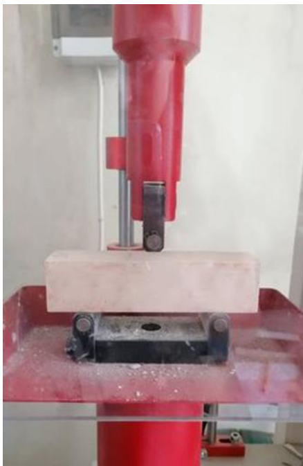
Σχήμα 3.14 Δοκιμή σε κάμψη τριών σημείων
