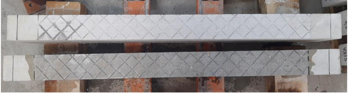
Σχήμα 3.26 Επιφάνεια δοκού πριν τη διαβροχή (πάνω) και επιφάνεια δοκού μετά τη διαβροχή (κάτω)
