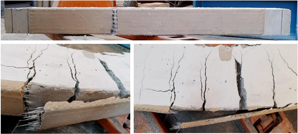
Σχήμα 4.27 (α) Όψη ενίσχυσης μετά την αποκόλληση, (β), (γ) κοντινή όψη ρωγμών, αποκόλλησης και λείας επιφάνειας σκυροδέματος
