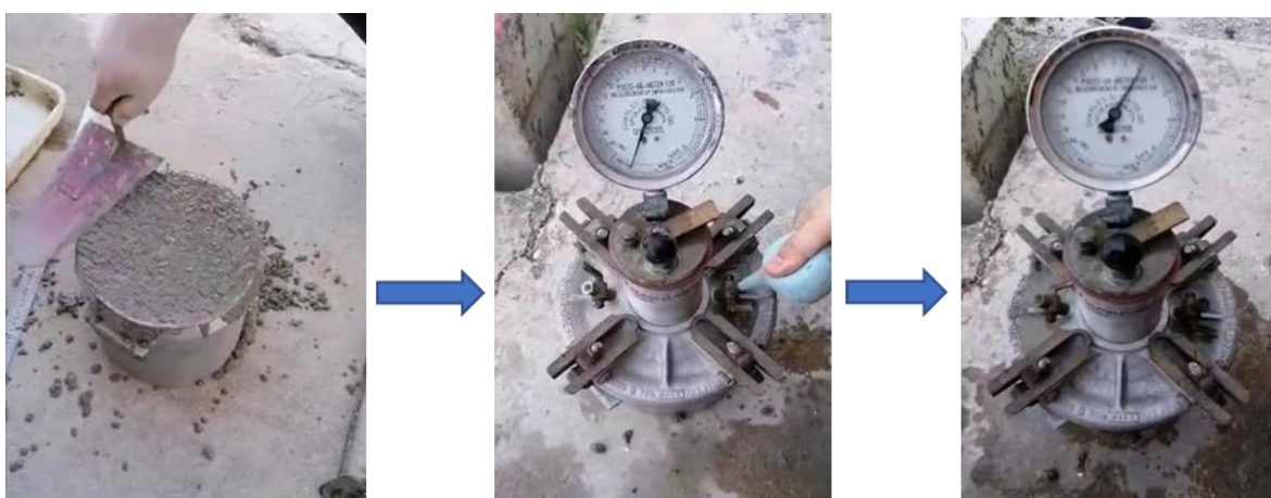
Σχήμα 3.22 Διαδικασία δοκιμής περιεκτικότητας σε αέρα
