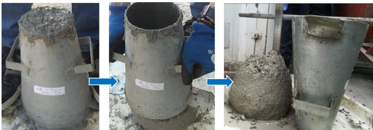
Σχήμα 3.21 Διαδικασία δοκιμής καθίζησης
