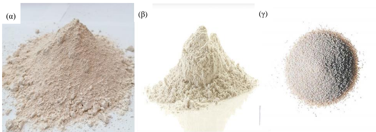
Σχήμα 3.11 (α) Σκόνη αργιλοπιριτίου, (β) Αδρανή < 0,5\text{mm} , (γ) Αδρανή 0,5\text{mm}-1\text{mm}
