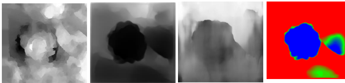
Εικόνα 4. 7 Χάρτες βάθους. Από αριστερά προς τα δεξιά εικονίζονται οι χάρτες βάθους όπως απαθανατίζονται από την κάμερα βάθους, το συνελκτικό δίκτυο DenseDepth , το συνελκτικό δίκτυο MonoDepth2 , την εφαρμογή των κανόνων Ασαφούς Λογικής στους χάρτες του δικτύου DenseDepth .
