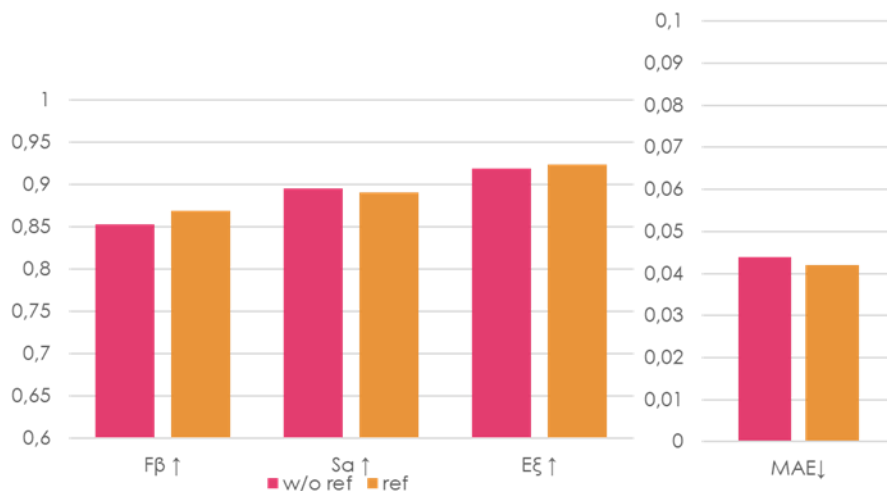
Εικόνα 5.4 Συνεισφορά του επιδιορθωτικού μηχανισμού στην ανίχνευση σημαντικών αντικειμένων που πραγματοποιήθηκε με χάρτες βάθους από το συνελικτικό δίκτυο MonoDepth2
