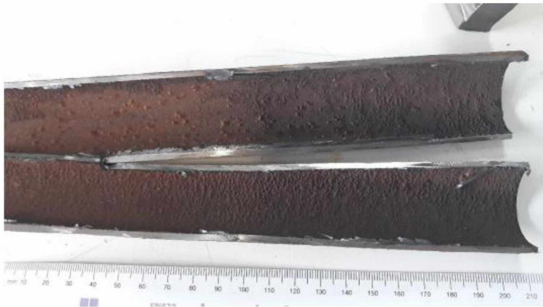
Εικόνα 37: Ομοιόμορφη διάβρωση στην εσωτερική επιφάνεια του σωλήνα. [23]
