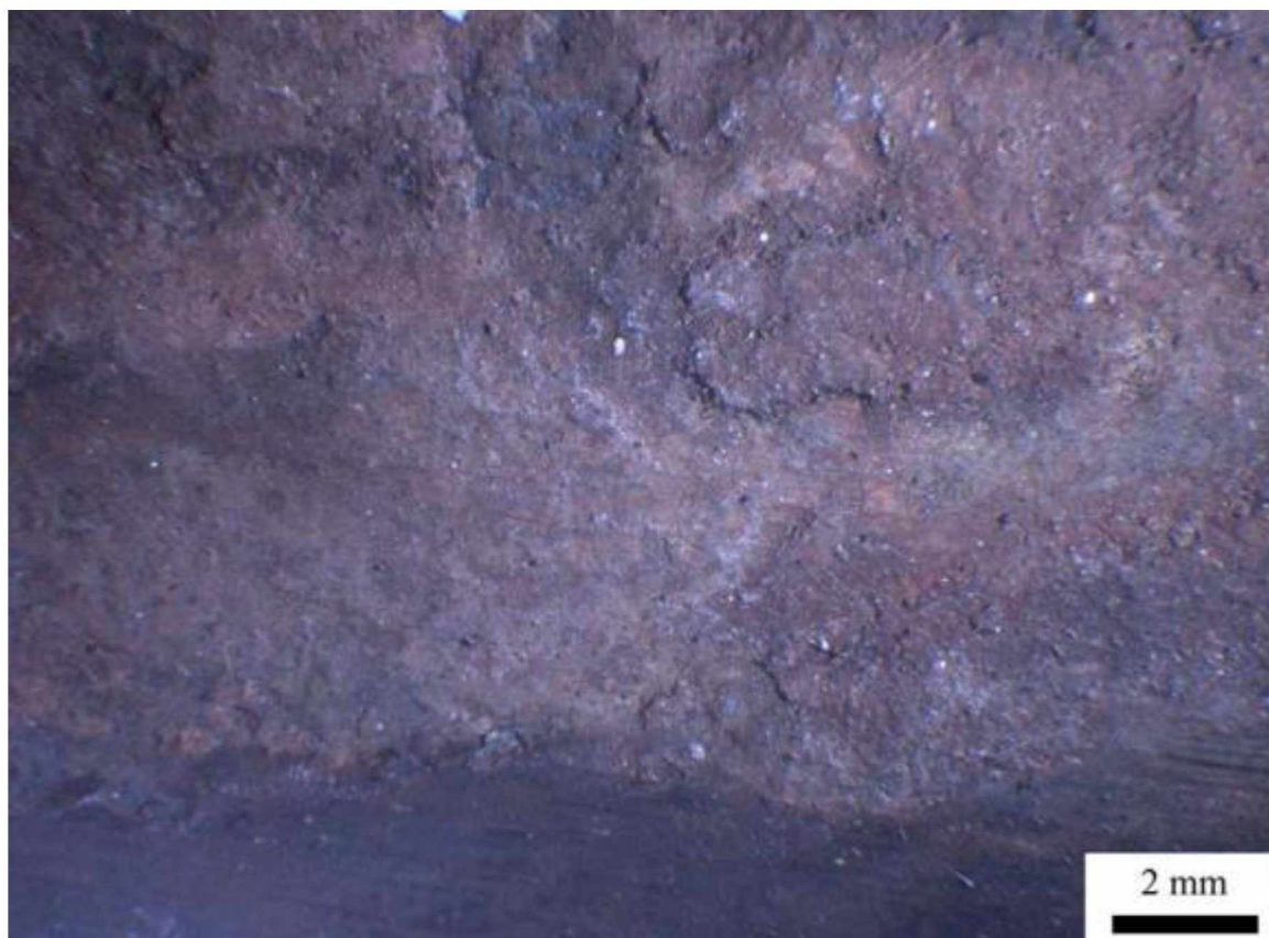
Εικόνα 53: Η περιοχή δίπλα στη διαρροή, η οποία δεν εμφανίζει προϊόντα διάβρωσης. [25]
