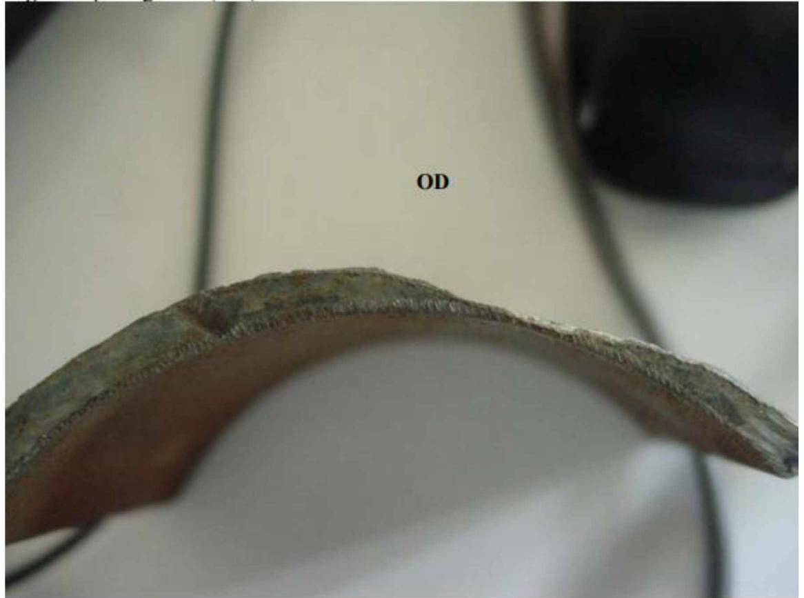
Εικόνα 51: Εγκάρσια κομμένο δοκίμιο κοντά στη διαρροή, όπου φαίνεται η μείωση πάχους τοιχώματος σωλήνα. [25]
