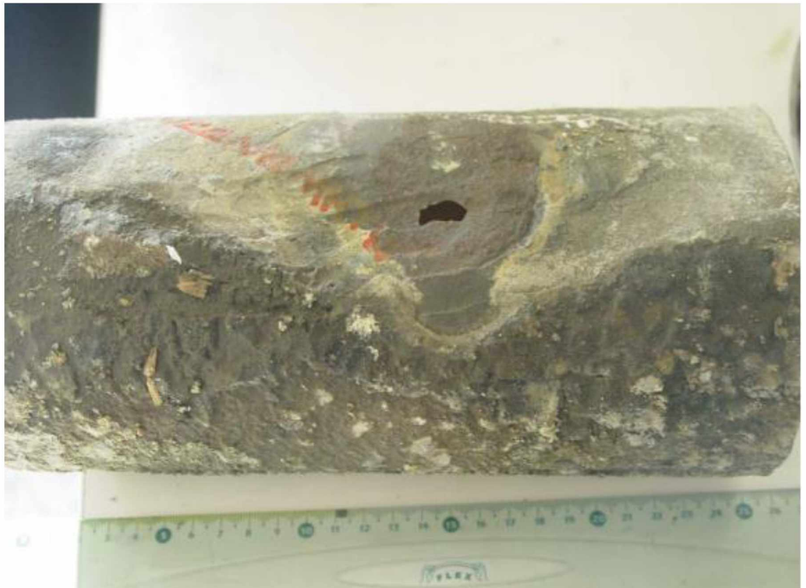
Εικόνα 50: Περιοχή διαρροής στο σωλήνα του ανακυκλωτή. [25]
