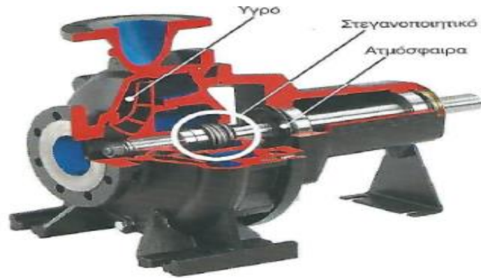
ΣΧΗΜΑ 4.12: Τυποποιημένη αντλία με μηχανικό στυπιοθλίπτη άξονα.
