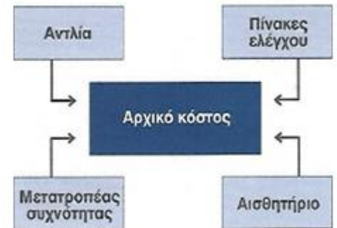
ΣΧΗΜΑ 4.37: Εξοπλισμός που αποτελεί ένα σύστημα
