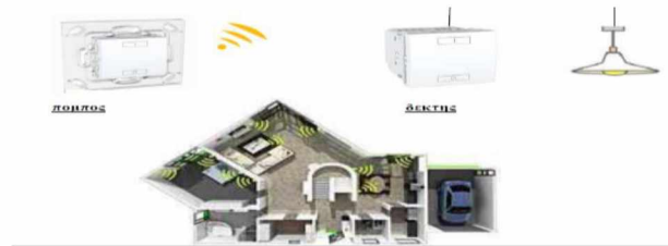
Σχήμα 1.5. Τοποθέτηση Πομπό – Δέκτη
