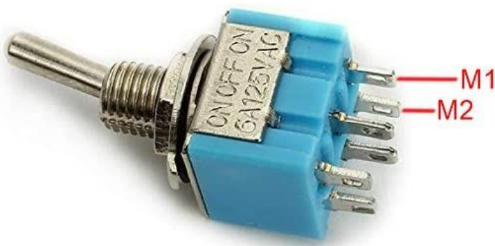
Εικόνα 3.14: PIN του MTS-203 για το τέταρτο στάδιο της συνδεσμολογίας.
