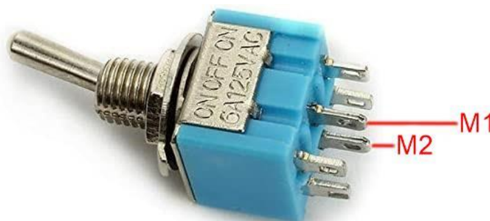
Εικόνα 3.13: PIN του MTS-203 για το τρίτο στάδιο της συνδεσμολογίας.
