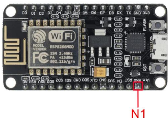
Εικόνα 3.10: PIN του NodeMCU για το δεύτερο στάδιο της συνδεσμολογίας.
