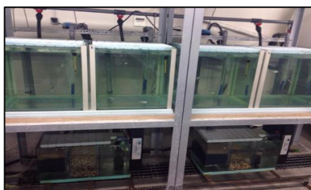
Εικόνα 2.1. Διάταξη δεξαμενών και απεικόνιση του συστήματος φιλτραρίσματος-αποστείρωσης.
