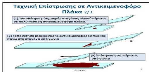
Εικόνα 3. Επίστρωση αίματος σε αντικειμενοφόρο πλάκα
