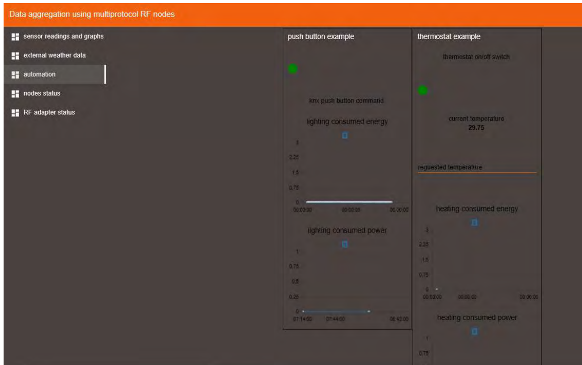
ΕΙΚΟΝΑ 51: ΚΑΡΤΕΛΑ ΕΝΔΕΙΞΗΣ ΧΕΙΡΙΣΜΩΝ ΑΥΤΟΜΑΤΙΣΜΟΥ ΣΤΟ USER INTERFACE ΤΟΥ NODE-RED
