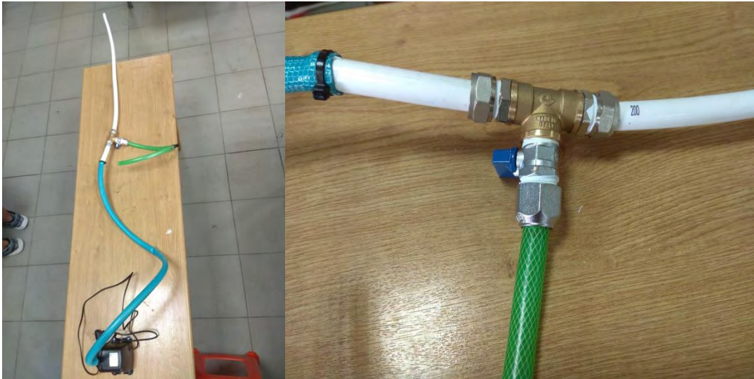
Εικόνα 3. Σωληνώσεις, γωνίες, ταφ, μούφα Φ32 (τύπου Valsir) που χρησιμοποιήθηκαν για τη συνδεσμολογία των σωληνώσεων των ενυδρειοπνικών συστημάτων και την κατασκευή του συστήματος απορροής (Πηγή: Προσωπικό αρχείο).
