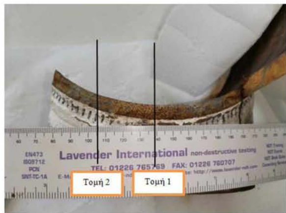
Εικ. 4.44 Τομές του X4 στην πλευρά της συγκόλλησης και της χορδής
