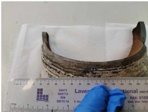
Εικ. 4.15 α) Επιφάνεια θραύσης X3 από την πλευρά της συγκόλλησης
