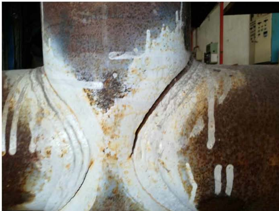
Εικ. 3.7 Διαμπερής αστοχία του δείγματος X1
