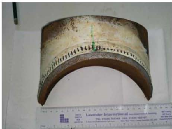
Εικ. 4.13 α) Επιφάνεια θραύσης X2 από την πλευρά της συγκόλλησης
