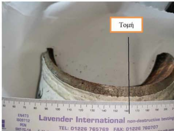
Εικ. Εικ. 4.21 α) Τομή επιφάνειας θραύσης του X1 στο σημείο (3), από την πλευρά της συγκόλλησης στο crown
