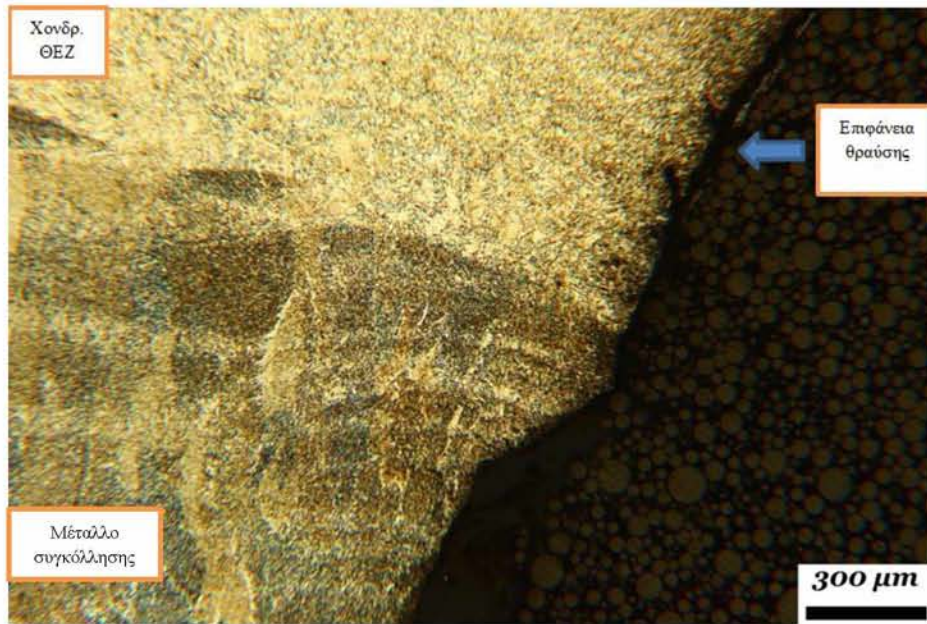
Εικ. 4.47 Μεταλλογραφία επιφάνειας θραύσης στο crown
