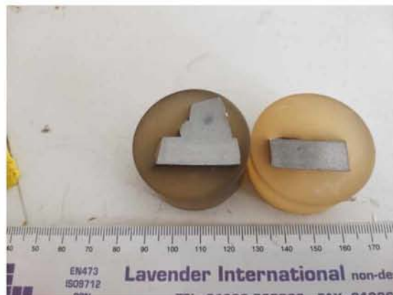
Εικ. 4.27 Εγκιβωτισμένα δοκίμια από την πλευρά της συγκόλλησης και την αντίστοιχη της χορδής στο X2 στο crown
