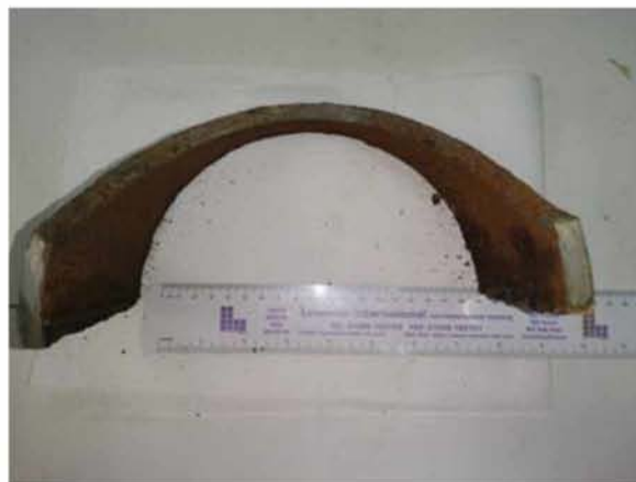
Εικ. 4.13 β) Επιφάνεια θραύσης X2 απέναντι από την συγκόλληση
