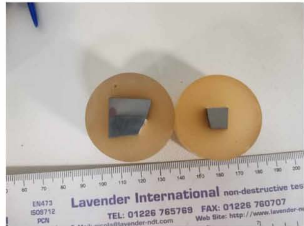
Εικ. 4.21 β) Δοκίμια μεταλλογραφίας από την πλευρά της συγκόλλησης και την αντίστοιχη της χορδής στο X1(3) στο crown
