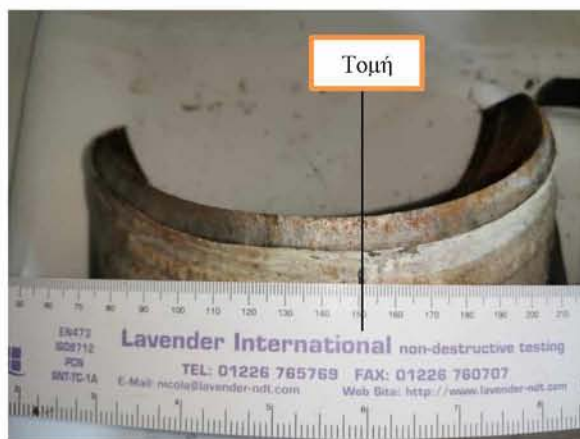
Εικ. 4.20 α) Τομή επιφάνειας θραύσης του X1 στο σημείο (1), από την πλευρά της συγκόλλησης στο crown
