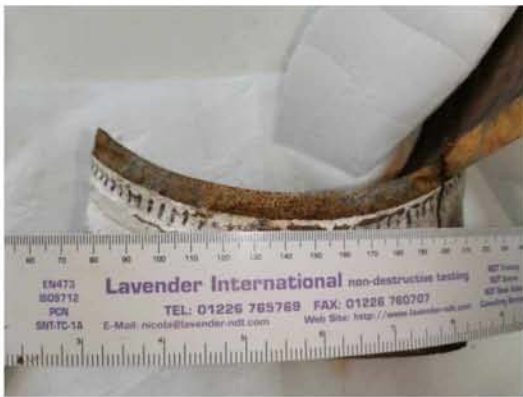
Εικ. 4.18 α) Επιφάνεια θραύσης X4 από την πλευρά της συγκόλλησης
