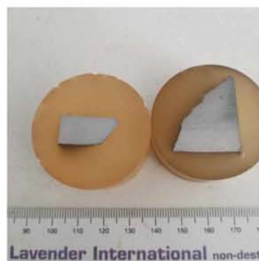
Εικ. 4.36 β) Εγκιβωτισμένα δοκίμια στην τομή 2 στο X3(4)
