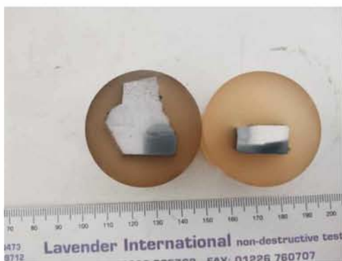
Εικ. 4.36 α) Εγκιβωτισμένα δοκίμια στο crown στο X3(4)
