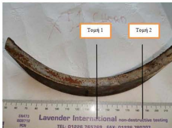
Εικ. 4.44 Τομές του X4 στην πλευρά της συγκόλλησης και της χορδής
