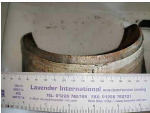
Εικ. 4.11 α) Επιφάνεια θραύσης X1 στην πλευρά της συγκόλλησης στο σημείο (1)
