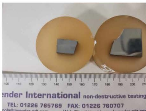
Εικ. 4.20 β) Δοκίμια μεταλλογραφίας από την πλευρά της συγκόλλησης και την αντίστοιχη της χορδής στο X1(1) στο crown
