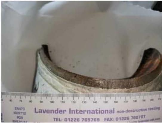
Εικ. 4.12 α) Επιφάνεια θραύσης X1 από την πλευρά της συγκόλλησης στο σημείο (3)
