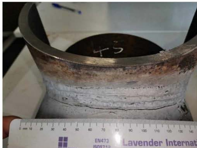
Εικ. 4.18 Δοκίμιο X3 στο σημείο (1) μετά τον έλεγχο με μαγνητικά σωματίδια
