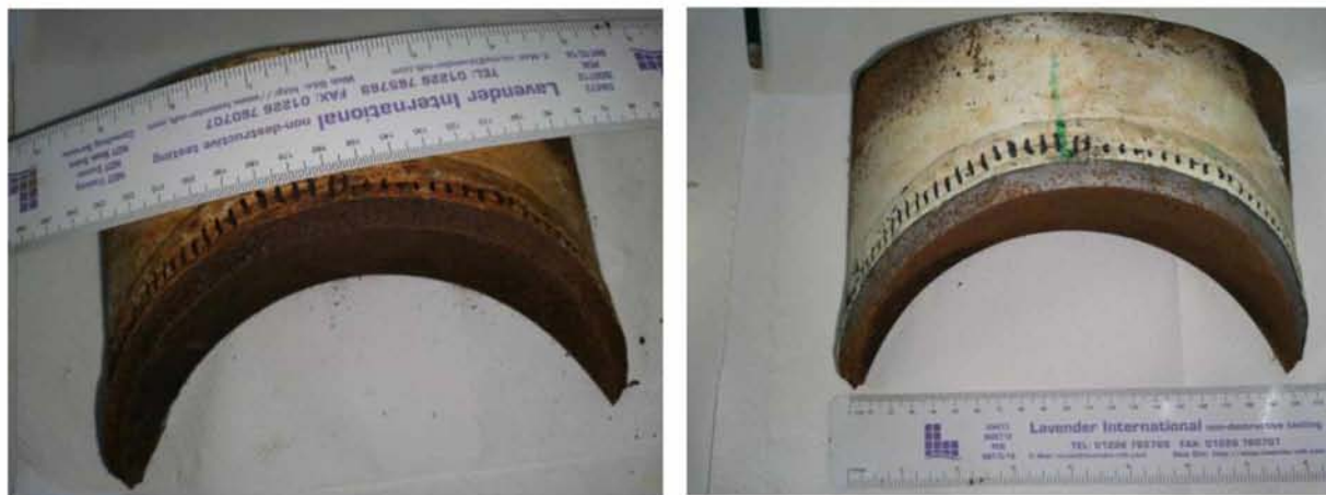
Εικ. 3.8 Επιφάνεια θραύσης πριν και μετά την χρήση βασιλικού ύδωρ
