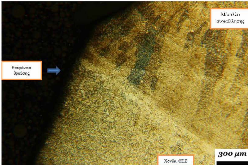
Εικ. 4.22 Μεταλλογραφία στην πλευρά της συγκόλλησης στο crown του X1(1)
