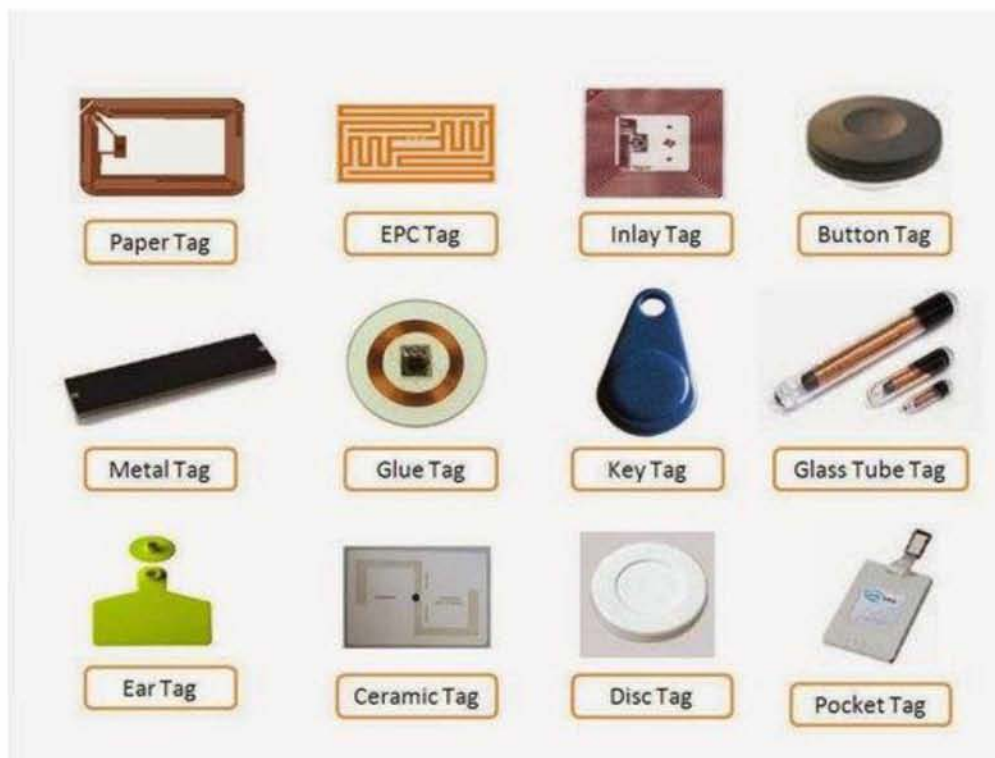
Εικόνα 5: Διάφορα είδη ετικετών RFID.
