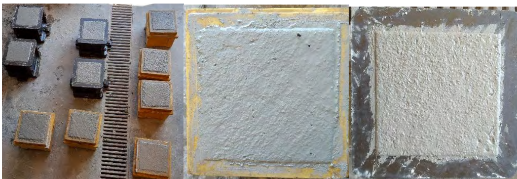
Εικόνα 3.8 : Μεταλλικές και ξύλινες κυβικές μήτρες πρότυπων διαστάσεων.
