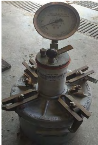
Εικόνα 3.11: Συσκευή μέτρησης πορώδους του σκυροδέματος
