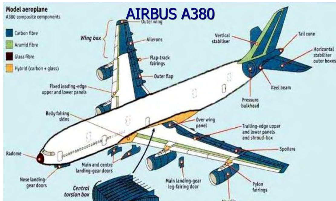
Εικόνα 1.2: Τμήματα αεροπλάνου κατασκευασμένα από ινοπλισμένα πολυμερή, 1ο συνέδριο στρατηγικής και τεχνολογίας, ένωση απόστρατων αξιωματικών αεροπορίας (2019)
