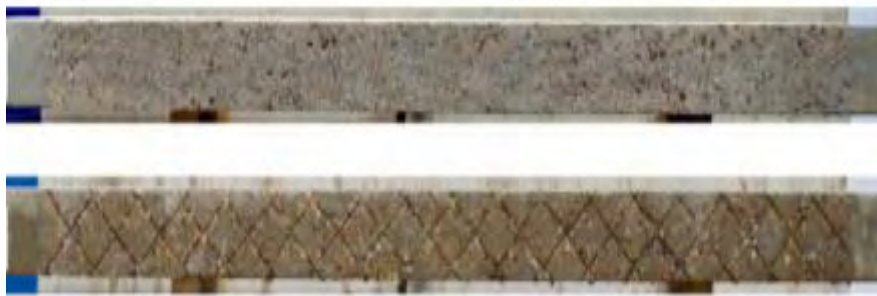
Εικόνα 2.7: Προετοιμασία επιφάνειας σκυροδέματος με τροχό ,Raouf et al. (2017)
