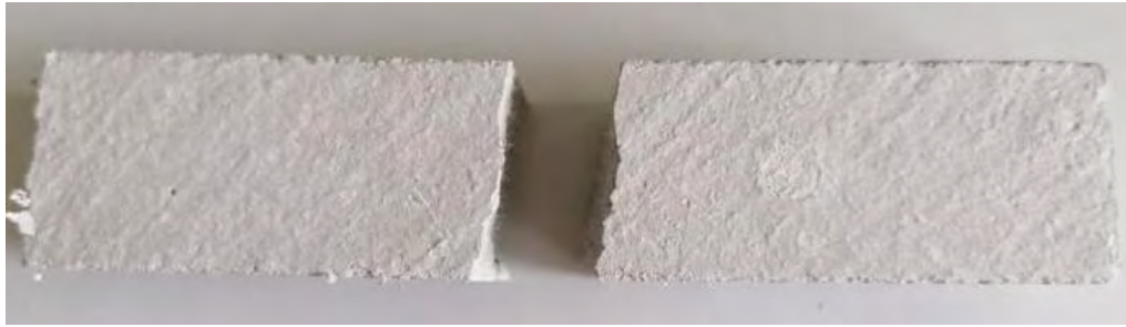
Εικόνα 3.27 : Μορφή αστοχίας πρίσματος του κονιάματος 2, σε δοκιμή 3 σημείων κάμψης Να σημειωθεί ότι οι διαστάσεις ήταν σε χιλιοστά: 160 το μήκος, 40 το πλάτος και ύψος. Οι διαστάσεις των κυβικών δοκιμίων σε χιλιοστά: 40 το πλάτος και μήκος
