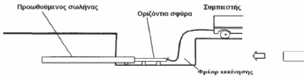
Εικόνα 3.3: Απεικόνιση έμπηξης ανοικτού σωλήνα με σφύρα
