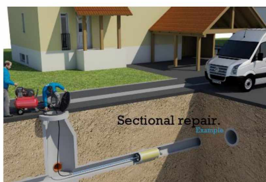
Εικόνα 3.10: Σημειακή επισκευή σωλήνα
