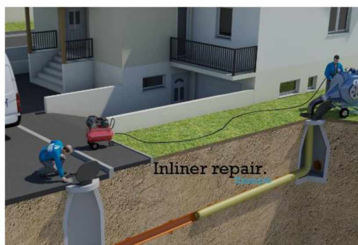
Εικόνα 3.9: Γραμμική επισκευή σωλήνα
