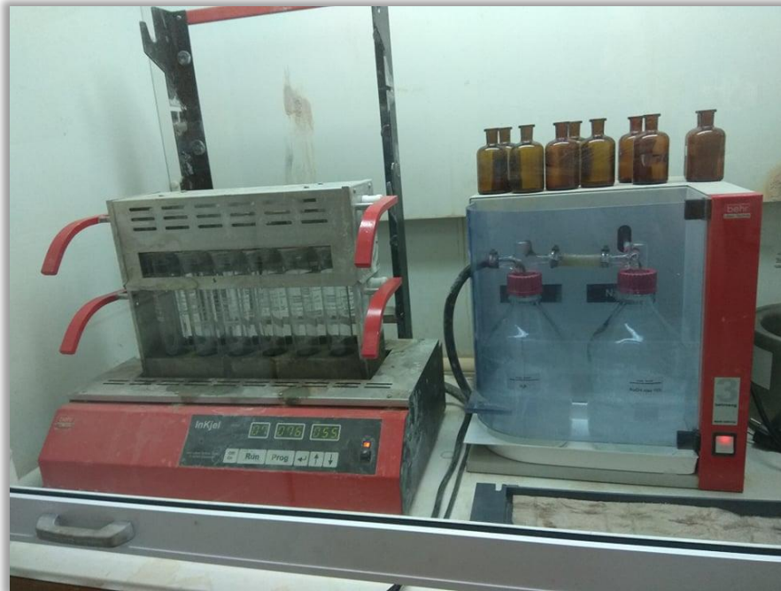
Εικόνα 7: Τοποθέτηση των φιαλών βρασμού σε ειδική συσκευή πέψης που ήταν τοποθετημένη σε επαγωγό (Πηγή: Προσωπικό αρχείο)
