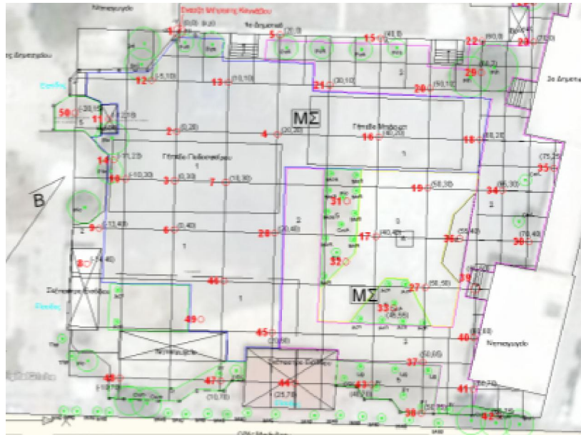
Εικόνα 3. Κάναβος σημείων μέτρησης στην αυλή του 1, 2ο Δημοτικό - 12ο Νηπιαγωγείο Νέας Ιωνίας
