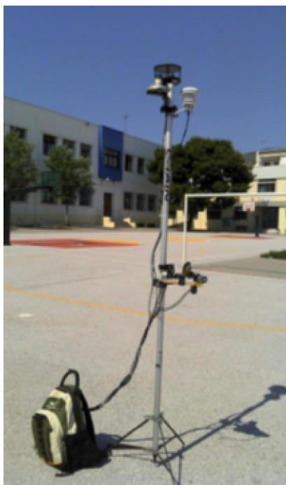
Εικόνα 2. Σύνθετος μετρητικός σταθμός για λήψη μικροκλιματικών δεδομένων
