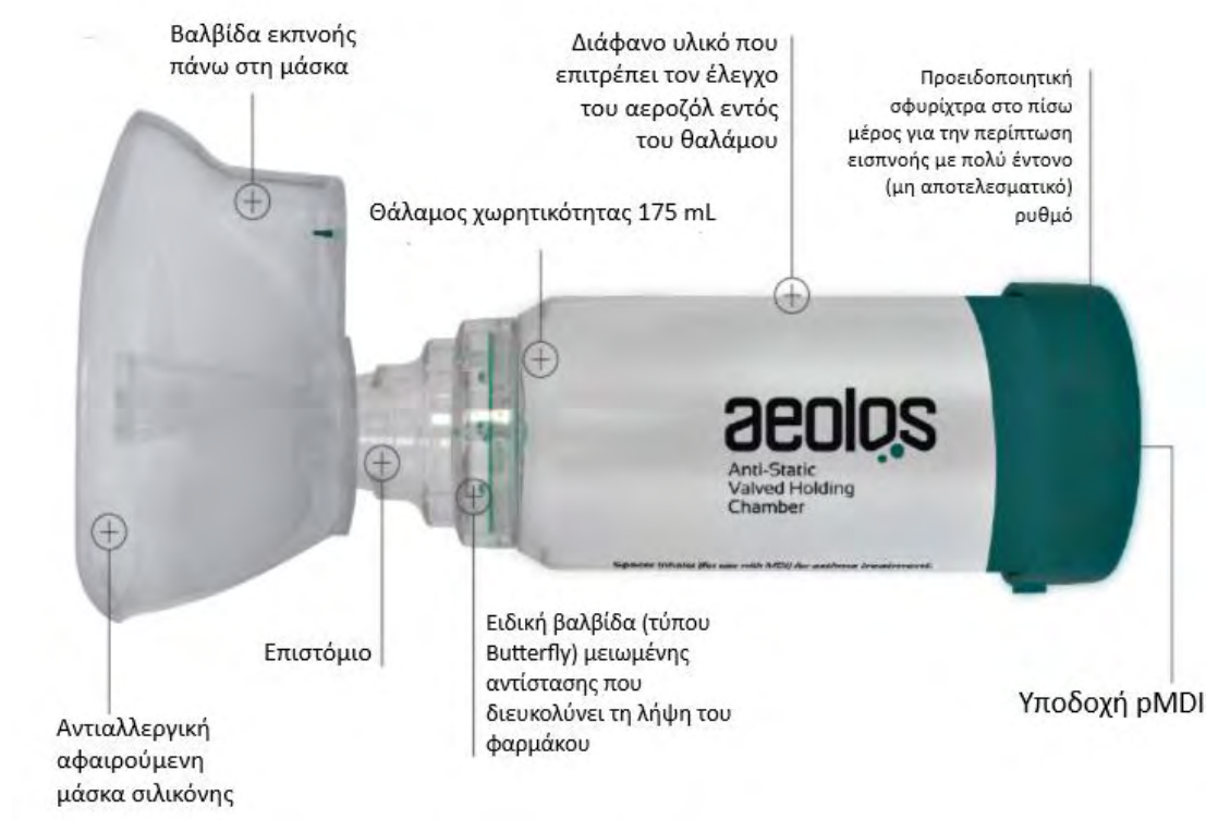
Σχήμα 4.18: Η συσκευή Aeolos και τα χαρακτηριστικά της (Πηγή: www.aeoloschamber.com/page/aeolos_adult )
