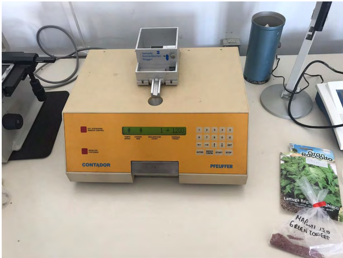
Εικόνα 1. 10: Συσκευή καταμέτρησης των σπόρων που χρησιμοποιήθηκαν στο πείραμα
