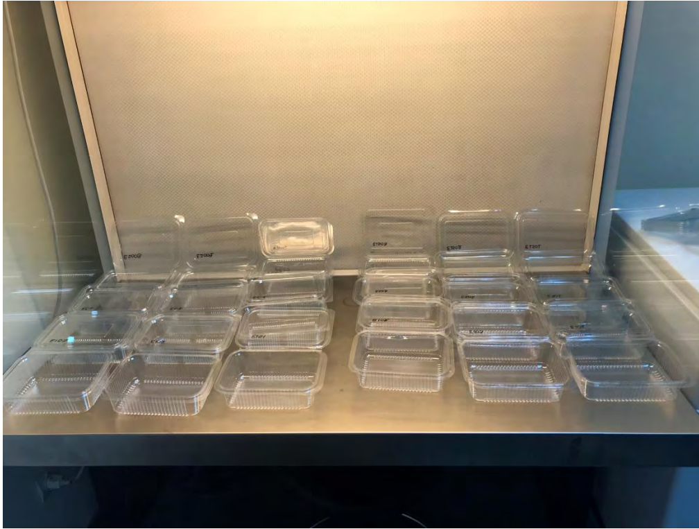
Εικόνα 1. 14: Αποστείρωση των πλαστικών κουτιών με έκθεση σε υπεριώδη ακτινοβολία (UV)
