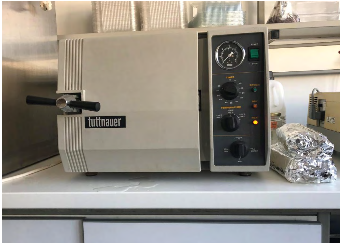
Εικόνα 1. 13 Αυτόκαυστο που χρησιμοποιήθηκε για την αποστείρωση των διαλυμάτων πολυαιθυλενικής γλυκόλης, χλωριούχου νατρίου και απιονισμένου νερού
