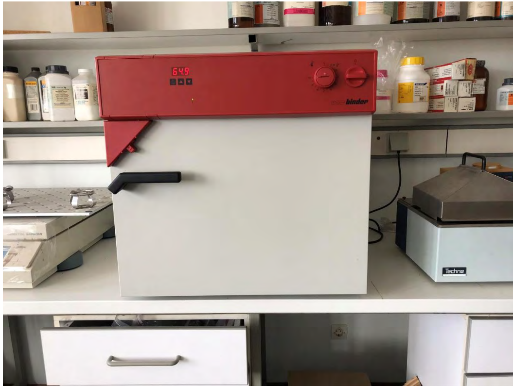
Εικόνα 1. 18: Ξηραντήριο για ξήρανση των σποροφύτων με σκοπό τη μέτρηση του ξηρού βάρους για να υπολογιστεί το ποσοστό περιεχόμενης υγρασίας σπορόφυτου
