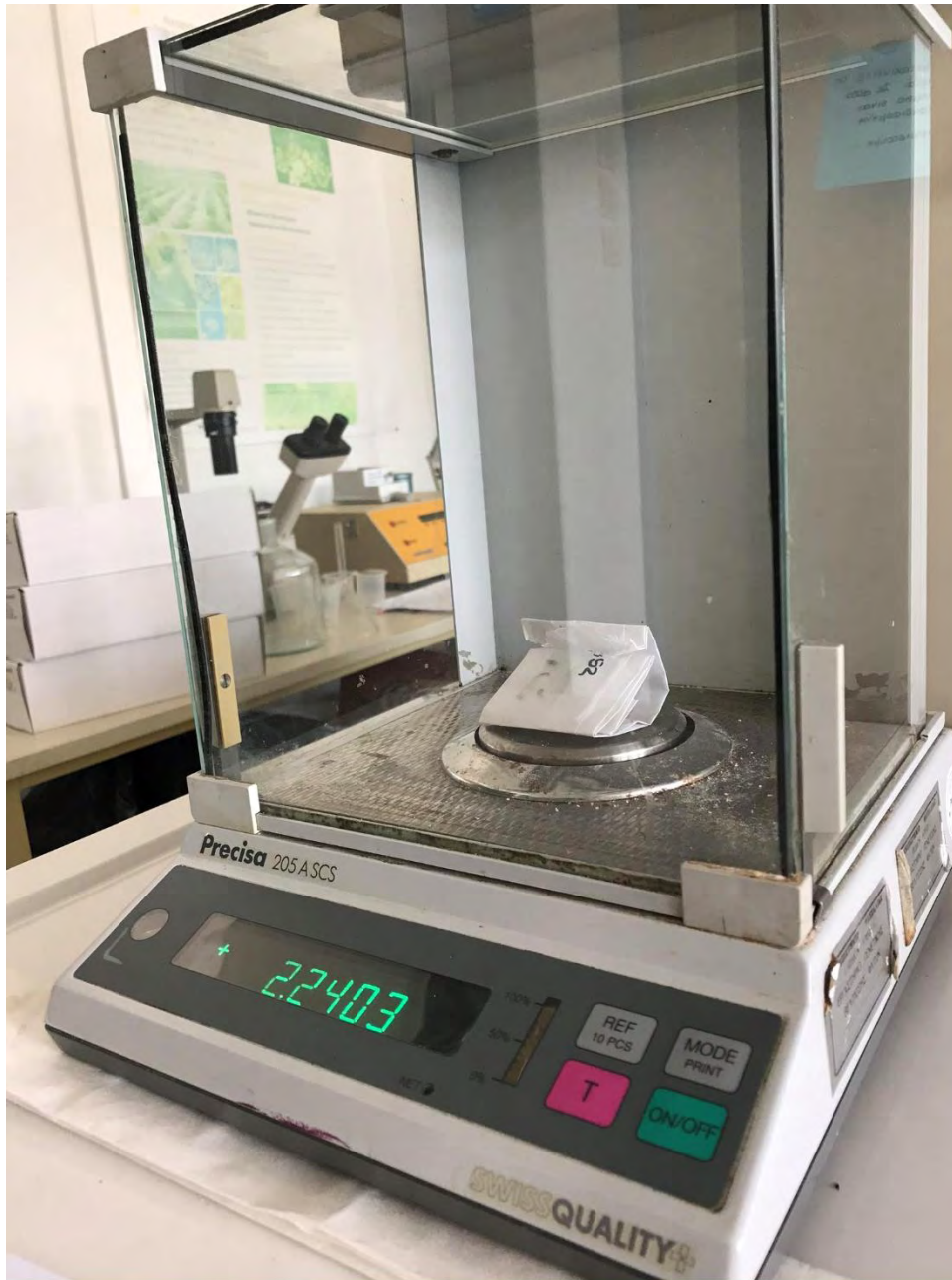
Εικόνα 1. 19: Καταγραφή του ξηρού βάρους για τον υπολογισμό του ποσοστού περιεχόμενης υγρασίας σπορόφυτου
