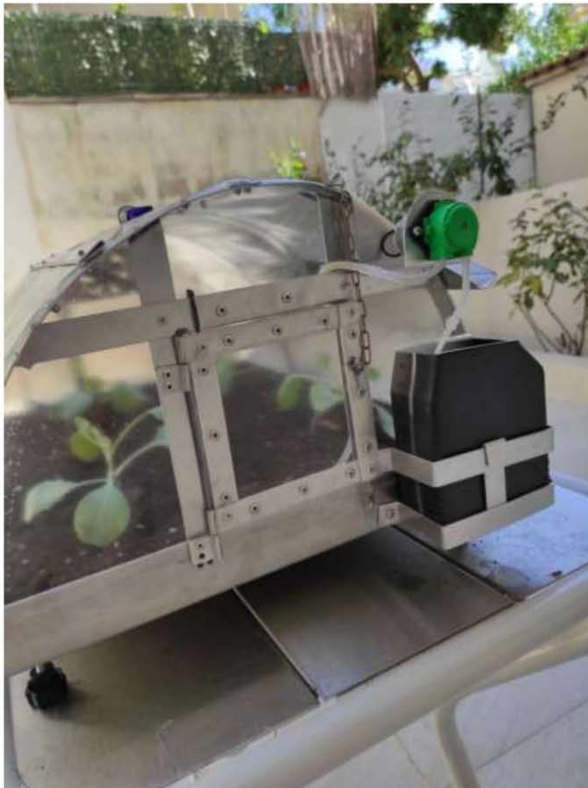
Εικόνα 11 – Αντλία νερού και νεπόζιτο αποθήκευσης νερού
