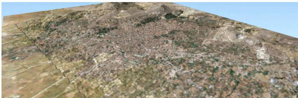
Εικόνα 0.2 Τρισδιάστατη απεικόνιση του Ψηφιακού μοντέλου επιφάνειας σε συνδυασμό οπτικό υπόβαθρο από το κτηματολόγιο -2-Ιδία επεξεργασία
