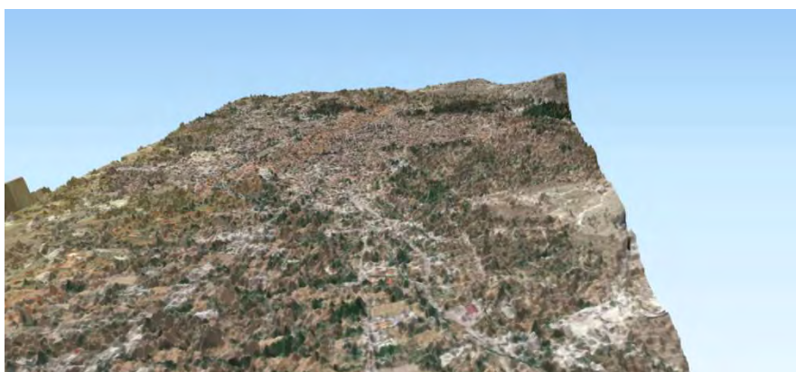
Εικόνα 0.3 Τρισδιάστατη απεικόνιση του Ψηφιακού μοντέλου επιφάνειας σε συνδυασμό οπτικό υπόβαθρο από το κτηματολόγιο -3-Ιδία επεξεργασία
