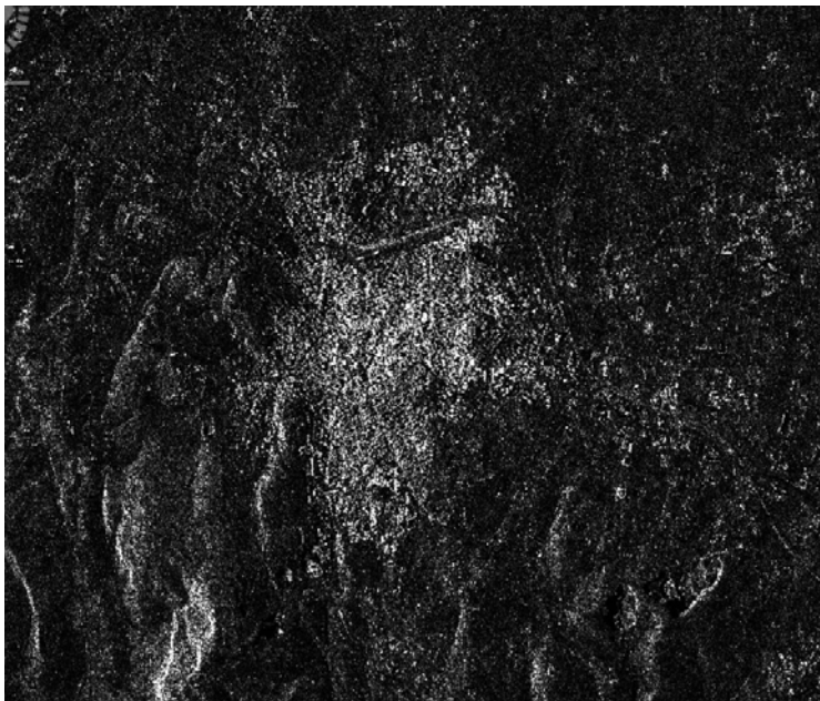
Εικόνα 3.10 Εικόνα ραντάρ μετά απο φίλτρο "Multilook" για την απαλοιφή των σιγμάτων – Ιδία επεξεργασία
