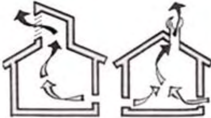
Εικόνα 5.8: Φαινόμενο της καμινάδας (Πηγή: cres.gr, 2020)
