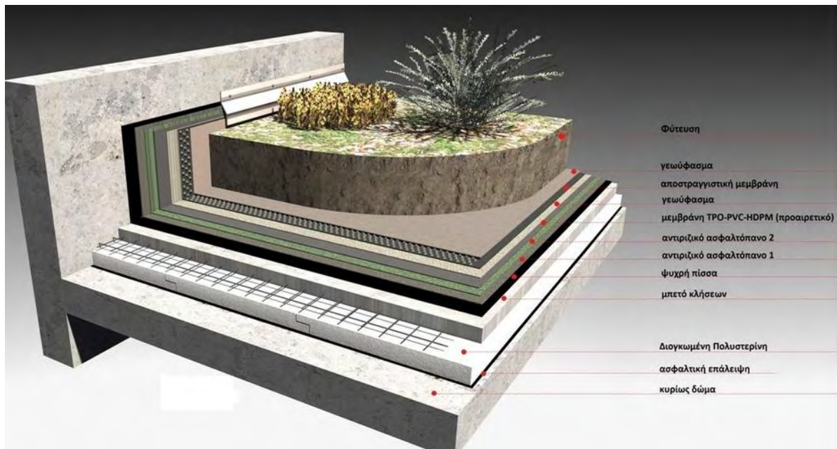
Εικόνα 5.9: Στρώσεις φυτεμένου δώματος (πηγή: http://www.ergatex.gr/insulation/roof/fitemeno_doma/ )
