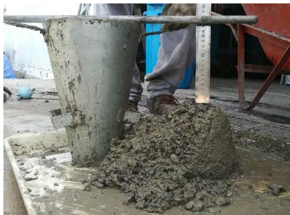
Σχήμα 3-9. Δοκιμή κάθισης στο ΕΤΚΟΣ.
