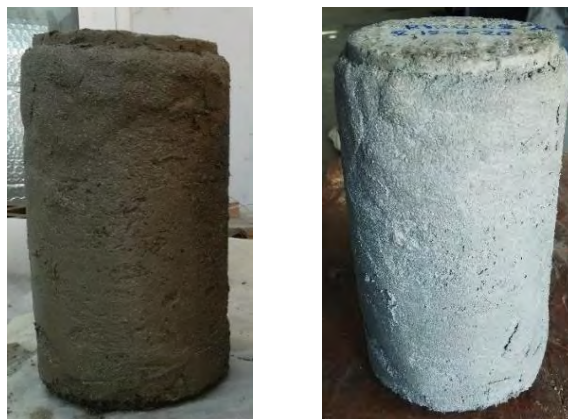
Σχήμα 3-14. (α) Δοκίμιο αμέσως μετά την εφαρμογή ενίσχυσης, (β) Δοκίμιο μετά τη σκλήρυνση της ενίσχυσης.
