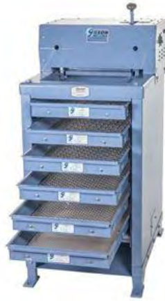
Σχήμα 3-1. Μηχανή κοσκίνισματος του ΕΤΚΟΣ.
