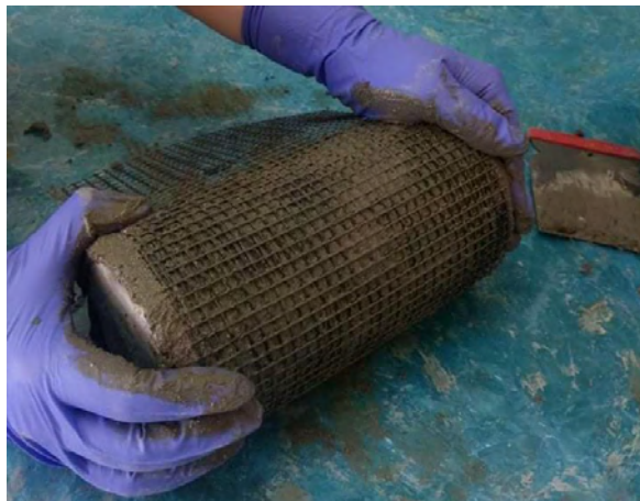
Σχήμα 3-13. Εφαρμογή περίσφιγξης σε δοκίμιο σκυροδέματος.
