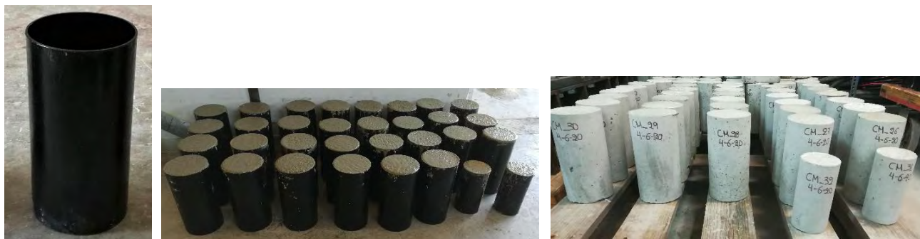
Σχήμα 3-11. (α) Πλαστικό καλούπι 100x200 mm, (β) νωπό σκυρόδεμα εντός των καλουπιών, (γ) συντήρηση των δοκιμών στο ΕΤΚΟΣ.
