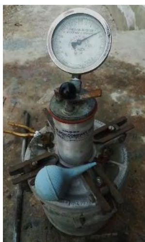
Σχήμα 3-10. Η συσκευή μέτρησης περιεχόμενου αέρα του ΕΤΚΟΣ.
