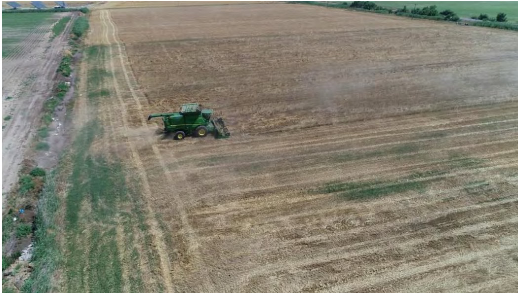
Εικόνα 16. Συγκομιδή του πιλοτικού αγρού με θεριζοαλωνιστική μηχανή John Deere S660i με σύστημα χαρτογράφησης της παραγωγής.
