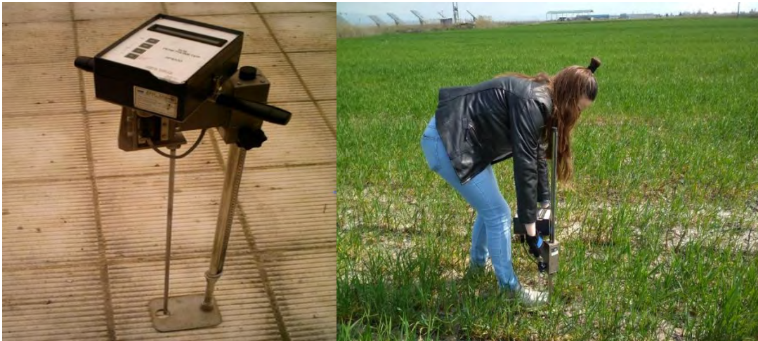
Εικόνα 14. Μέτρηση της αντίστασης του εδάφους στη διείσδυση με διεισδυσιόμετρο SP1000 (Findlay Irvine).
