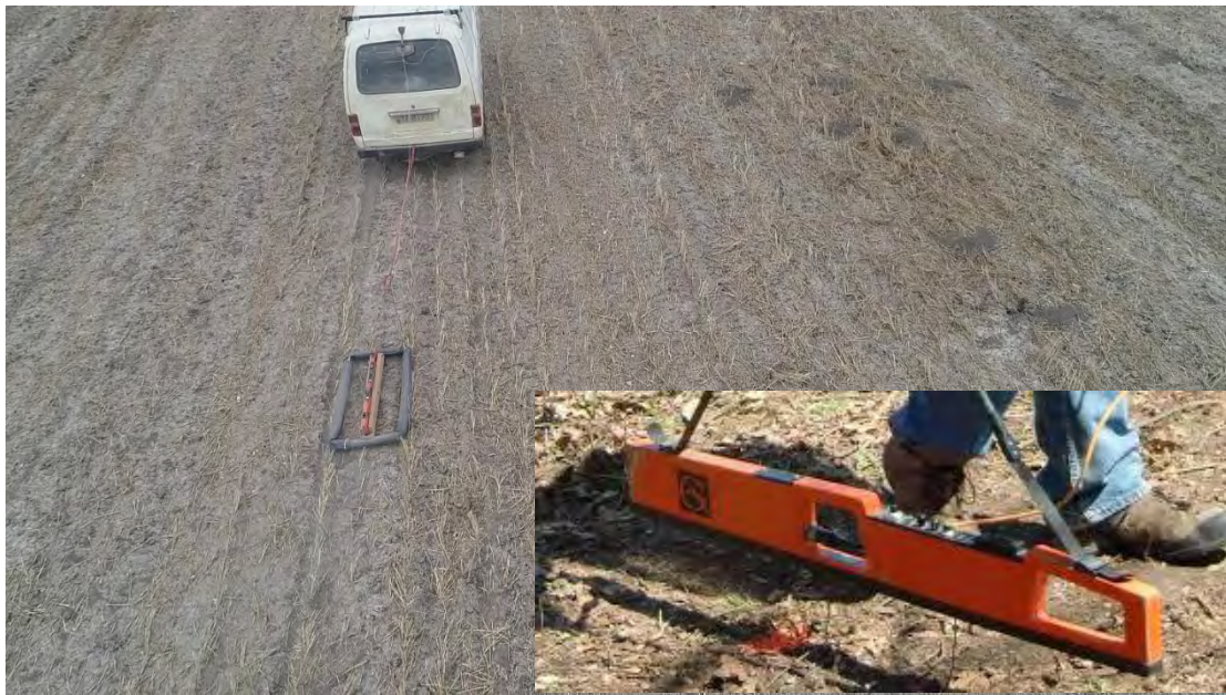
Εικόνα 12. Μέτρηση της ηλεκτρικής αγωγιμότητας του εδάφους με το όργανο EM-38 με σάρωση του αγρού με έλκηθρο (μεγάλη εικόνα) και με βάδιση (ένθετη εικόνα).
