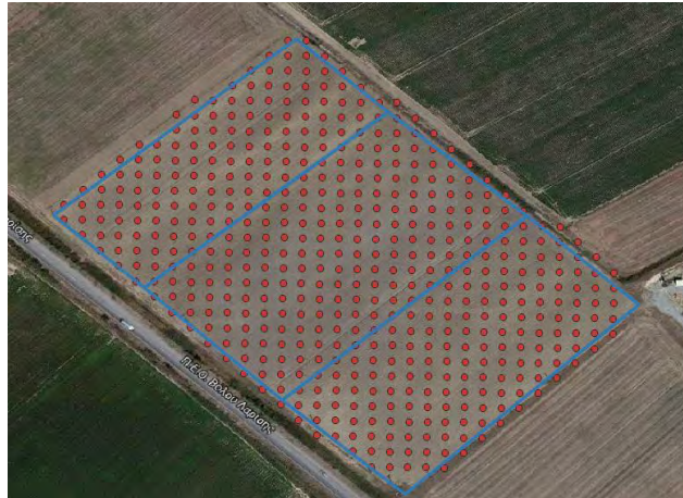
Εικόνα 15. Οι σημειακές μετρήσεις της αντίστασης στη διείσδυση του εδάφους.
