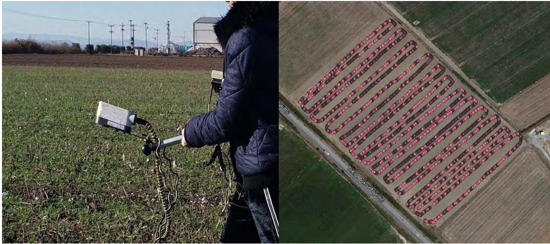
Εικόνα 11. Αισθητήρας Crop Circle ACS-210 για αποτύπωση του δείκτη βλάστησης NDVI της καλλιέργειας (αριστερά) και πορεία της δειγματοληψίας στον αγρό (δεξιά).
