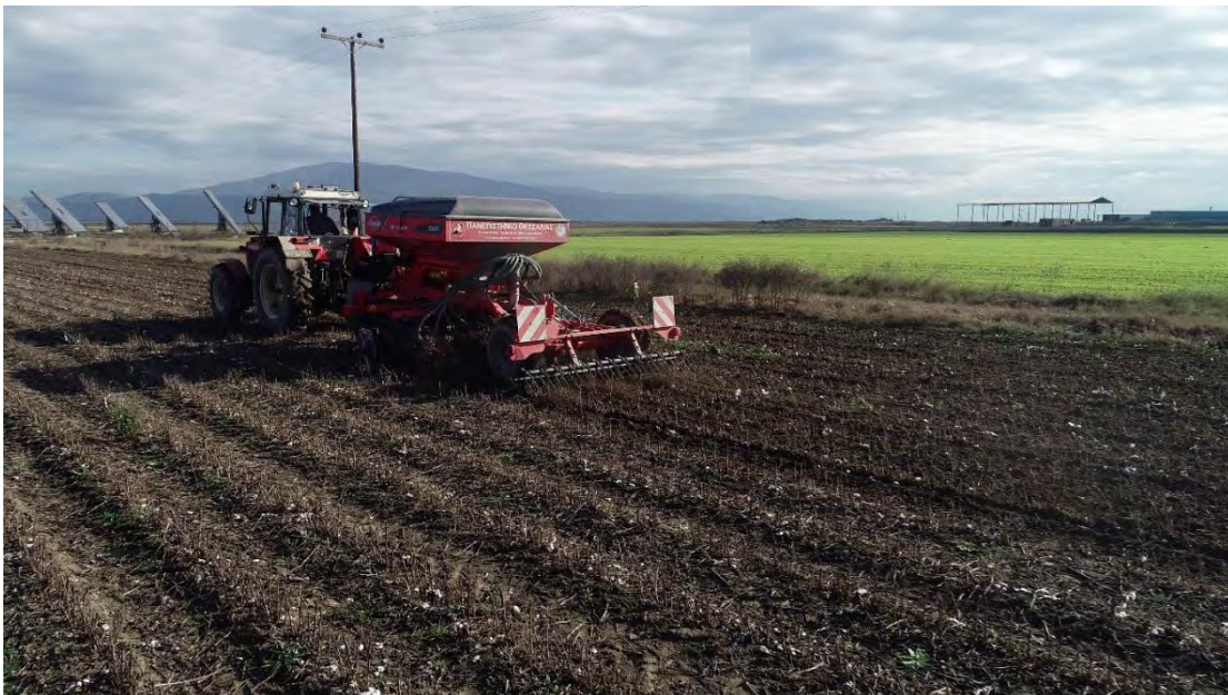
Εικόνα 4. Απ' ευθείας σπορά σίτου με την ειδική σπαρτική μηχανή του Πανεπιστημίου Θεσσαλίας.
