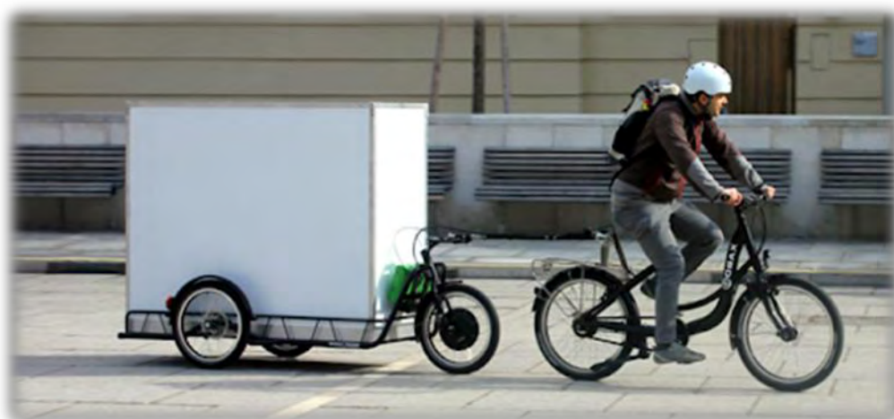
Σχήμα 6-4: Ρυμουλκούμενο Cargo bike με περιστρεφόμενο άξονα (Πηγή: cargobikefestival.com ).
