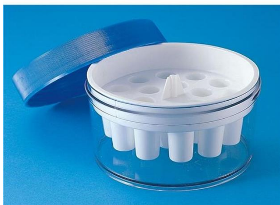
Εικόνα 17: Το freezing box που χρησιμοποιείται κατά την κρυσταλλοποίηση. Φαίνεται ο κενός χώρος μέσα στο διάφανο πλέξιγκλας που γεμίζεται με προπανόλη, καθώς και οι θέσεις για τα cryovials που καταβυθίζονται στην αλκοόλη (Ανατύπωση από: labgenome.com/5100-0001-thermo-scientific-nalgene-mr-frosty-cryo-freezing-container-case-of-1 )
