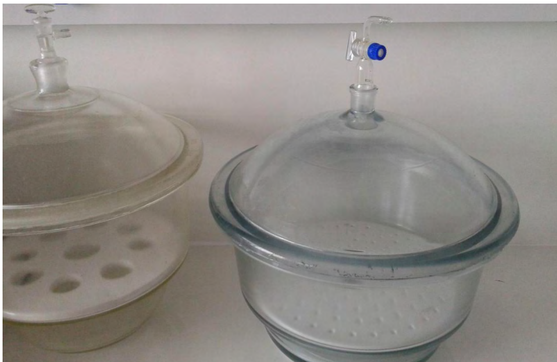
Εικόνα 3 Ξηραντήρας που χρησιμοποιήθηκε για την αποστείρωση με χλωροφόρμιο
