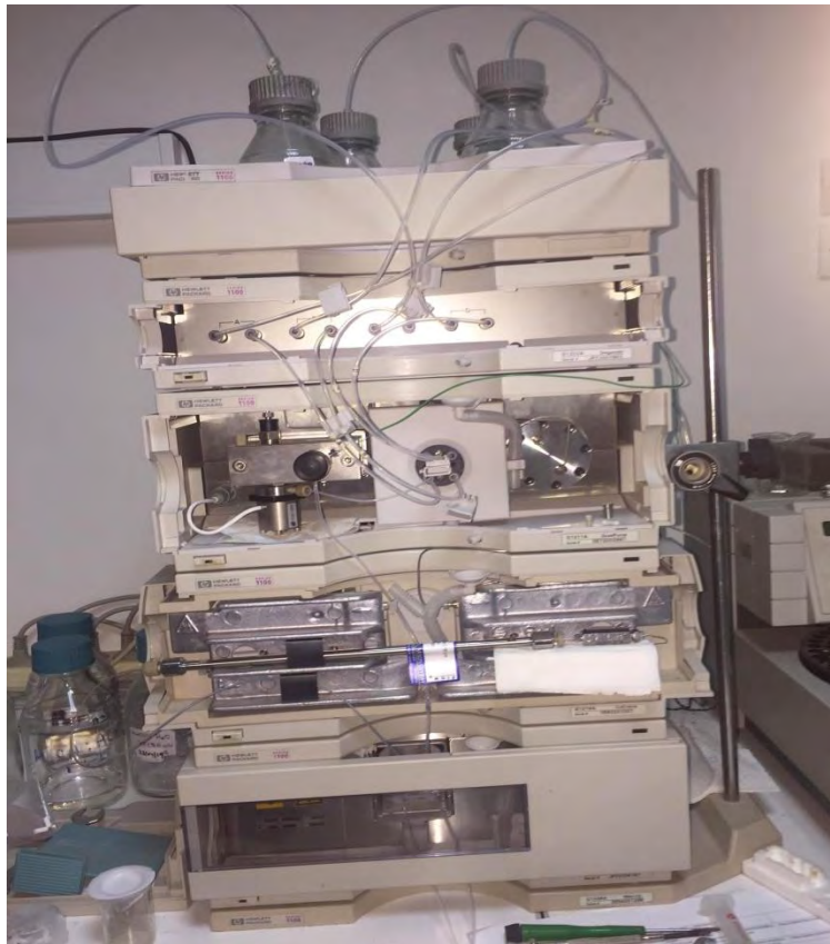
Εικόνα 11. Σύστημα γρήρης χρωματογραφίας HPLC.
