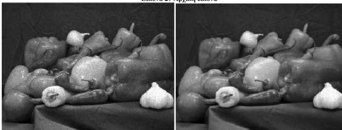
Εικόνα 30 (α) Θορυβοποιημένη εικόνα (αριστερά) | (β) Εφαρμογή Αλγορίθμου Βελτιστοποίησης Καταγισμού Ιδεών με Διδιάστατο Διακριτό Μετασχηματισμό Κυματιδίου και παραγωγή αποθορυβοποιημένης εικόνας (δεξιά)
