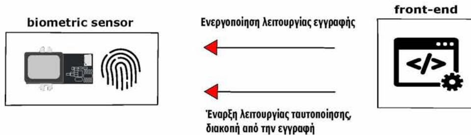
Σχήμα 4.24: Επικοινωνία biometric sensor με front-end.
