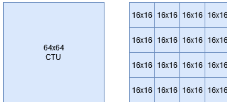
Εικόνα 9: Ένα CTU μεγέθους 64x64 σε σύγκριση με το πλήθος των μακρομπλοκ μεγέθους 16x16 που απαιτούνται για να καλύψουν μια περιοχή μεγέθους 64x64
