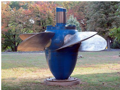
Εικόνα 8: Στρόβιλοι τύπου Kaplan
