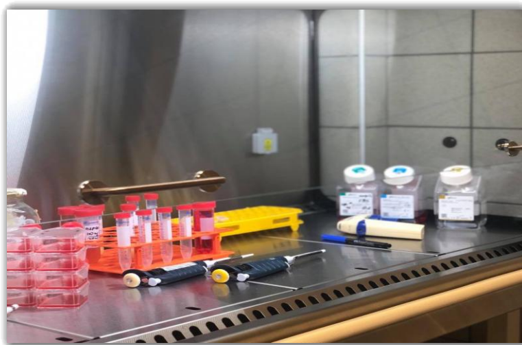
Εικόνα 35: Θάλαμος καθέτου νηματικής ροής αέρα στον οποίο εφαρμόστηκαν όλες οι τεχνικές πάνω στα κύτταρα
