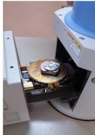
Εικόνα 11: Εισαγωγή δειγμάτων στο ηλεκτρονικό μικροσκόπιο σαρώσεως (SEM)
