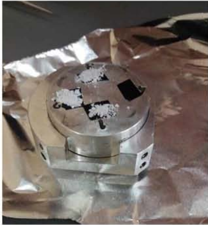
Εικόνα 10: Προετοιμασία δειγμάτων για την πραγματοποίηση της μεθόδου φασματοσκοπίας ακτίνων Χ(EDS)
