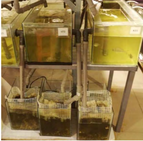
Εικόνα 2. Ενυδρεία συστήματα ανακυκλοφορίας νερού με το αντίστοιχο φίλτρο τύπου sump του συστήματος ενυδρειοπονίας (στο φίλτρο διαφαίνεται το μηχανικό και το βιολογικό φίλτρο) (Πηγή: προσωπικό αρχείο).
