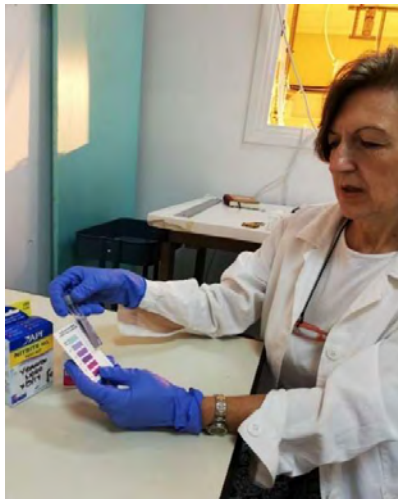
Εικόνα 7 (β). Χρωματικός προσδιορισμός \text{NO}_2^- (Πηγή: προσωπικό αρχείο)
