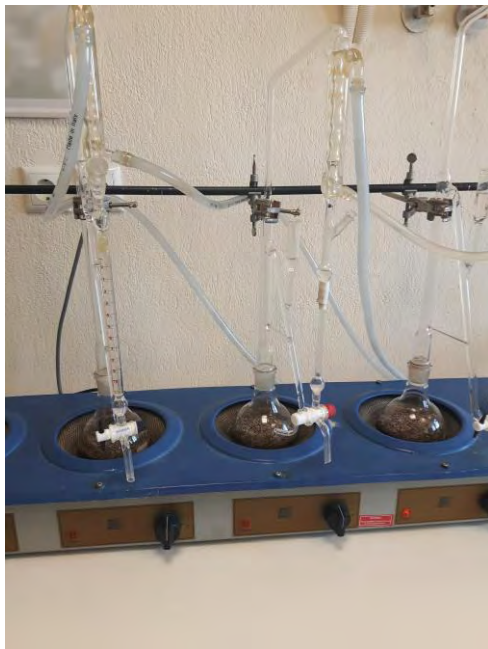
Εικόνα 26: Απόσταξη με Clevenger
