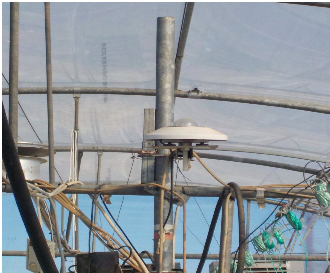
Εικόνα 2.10: Πυρανόμετρο τοποθετημένο κοντά στην οροφή του θερμοκηπίου.
