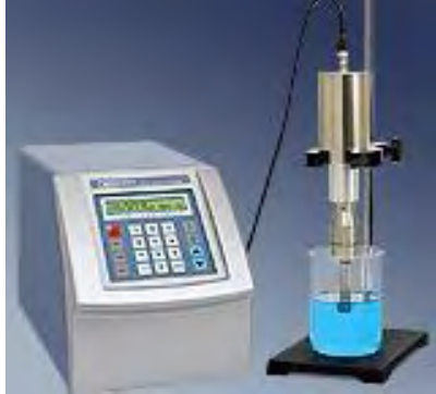
Εικόνα 6. Συσκευές Υπερήχων. Α. Με Στέλεχος. Β. Λουτρό Υπερήχων.
