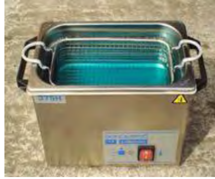
Εικόνα 6. Συσκευές Υπερήχων. Α. Με Στέλεχος. Β. Λουτρό Υπερήχων.
