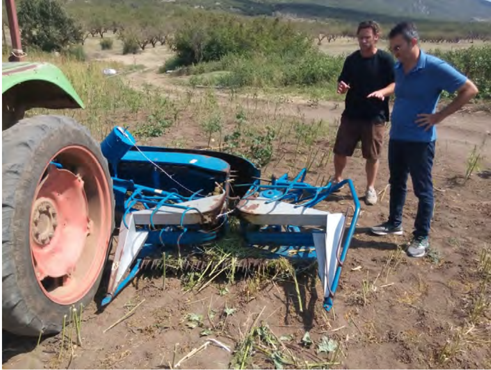
Εικόνα 14. Παρελκόμενη συλλεκτική μηχανή
