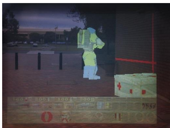
Παράδειγμα εικόνας που προβάλλεται στο χρήστη του παιχνιδιού ARQuake από το HMD, όπου φαίνεται τόσο ο πραγματικός κόσμος όσο και ο κόσμος που παράγεται από τον υπολογιστή.
