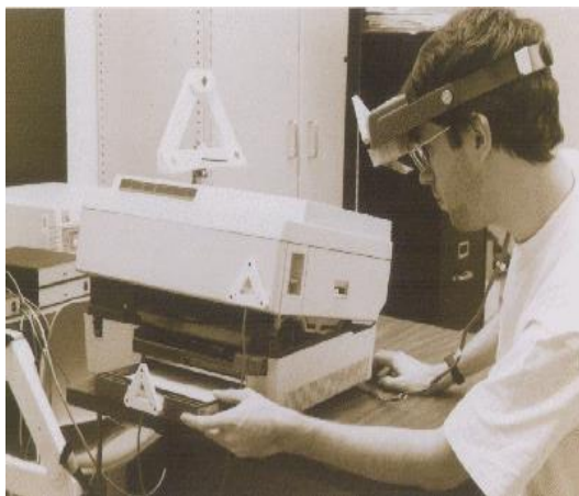
Σύστημα επαυξημένης πραγματικότητας KARMA [αριστερά] και εικόνα που βλέπει ο χρήστης μέσω της συσκευής θέασης [δεξιά].
