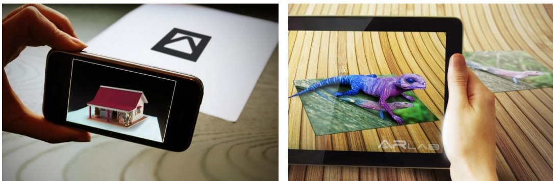
Παράδειγμα επαυξημένης πραγματικότητας βασισμένης σε markers (marker-based AR) [αριστερά] και σε φυσικά χαρακτηριστικά του αντικειμένου (markerless AR) [δεξιά].
