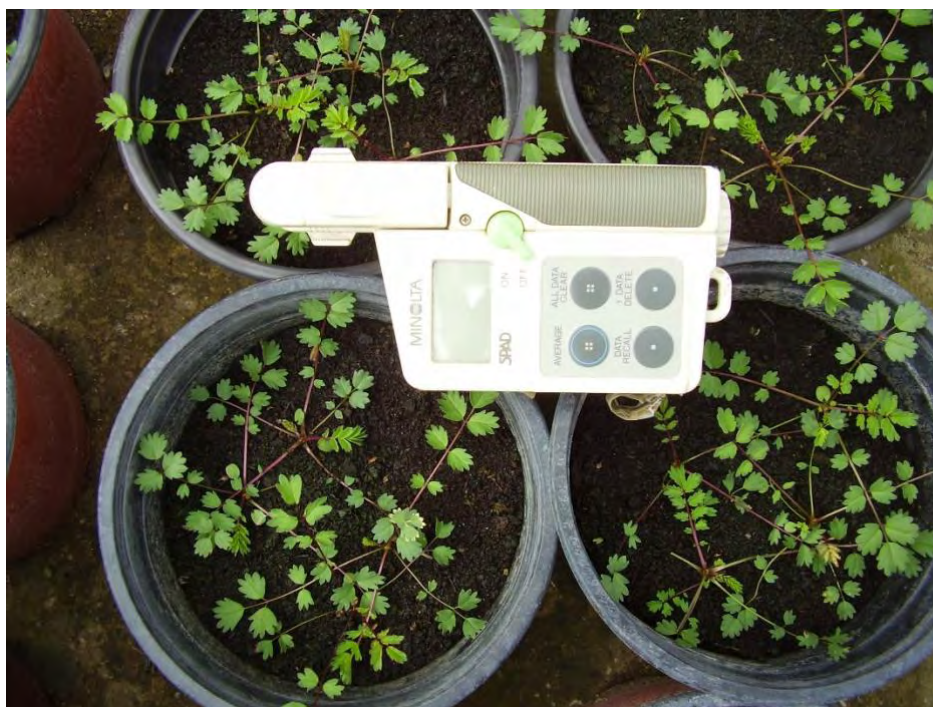
Εικόνα 3. Φορητό όργανο μέτρησης της χλωροφύλλης: SPAD-502 chlorophyll meter (Konica Minolta Optics Inc.).
