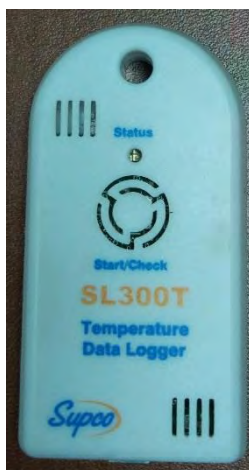
Εικόνα 2. Ο Supco SL300T temperature data logger που χρησιμοποιήθηκε για την καταγραφή της θερμοκρασίας του αέρα στο εσωτερικό του θερμοκηπίου.
