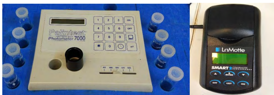
Εικόνα 5 : Τα δύο διαφορετικά χρωματόμετρα που χρησιμοποιήθηκαν για τη μέτρηση της συγκέντρωσης των θρεπτικών στοιχείων στα φύλλα των φυτών των μεταχειρίσεων
