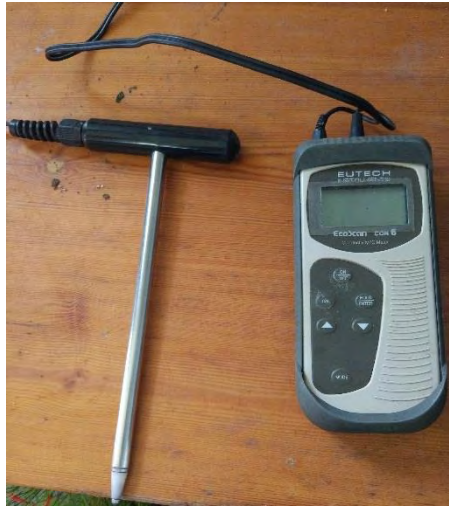
Εικόνα 3 Το αγωγιμόμετρο εδάφους με το οποίο ελήφθησαν οι μετρήσεις αγωγιμότητας του υποστρώματος
