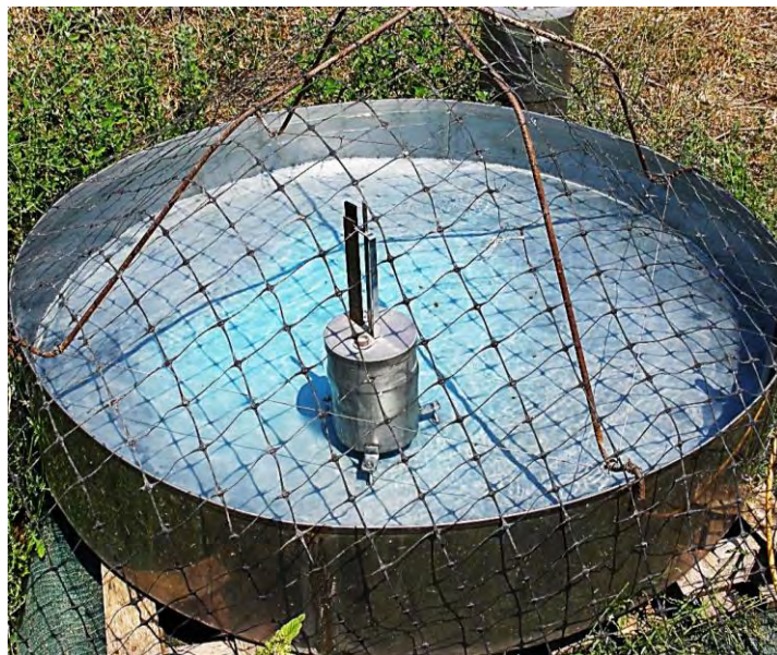
Εικόνα 4.2. Απλό εξατμισόμετρο τύπου Α εγκατεστημένο στον πειραματικό αγρό.
