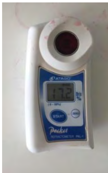
Εικόνα 2.16 Μέτρηση των ΔΣΣ με τη βοήθεια του διαθλασίμετρου
