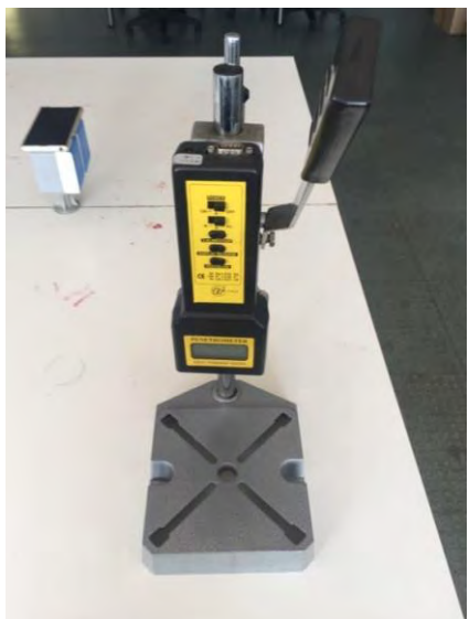
Εικόνα 2.11 Μέτρηση της σκληρότητας των καρπών με τη βοήθεια πενετρόμετρου
