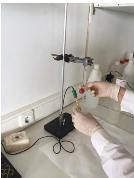
Εικ. 2.18 Τιτλοδότηση του διαλύματος χυμού με τη βοήθεια πεχαμέτρου
