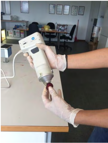
Εικόνα 2.7 Μέτρηση χρώματος φλοιού των καρπών με τη βοήθεια χρωματομέτρου
