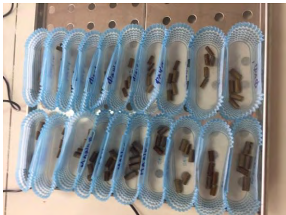
Εικ 2.6 Τοποθέτηση δειγμάτων σε ξηραντήρα σε θερμοκρασία 80 °C
