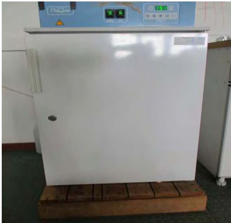
Εικόνα 3. Θάλαμος ελεγχόμενων συνθηκών για τον έλεγχο της βλαστικότητας σπόρων.
