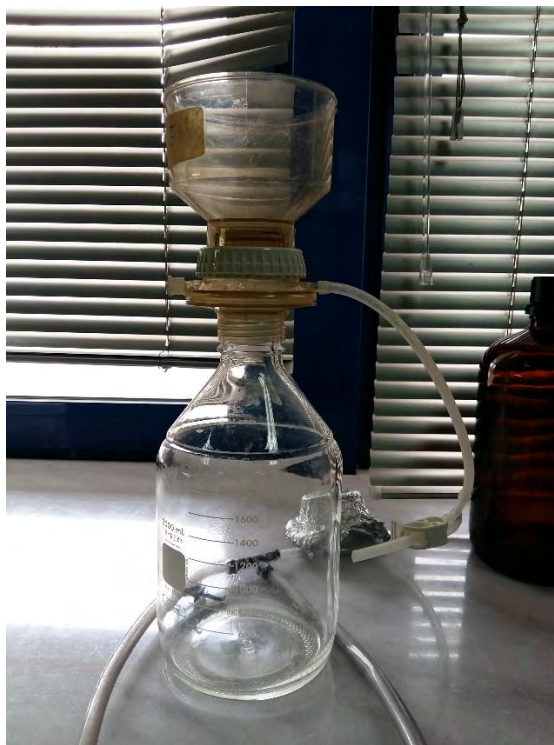
Εικόνα 4: Συσκευή διήθησης νερού(προσωπικό αρχείο)
