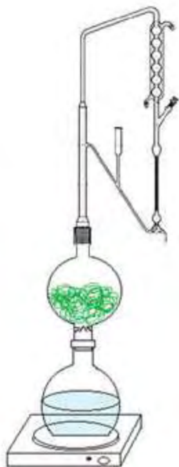
Εικόνα 4 : Απόσταξη με ατμό με αποστακτική διάταξη τύπου Clevenger
