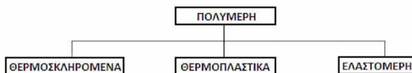
Σχ. 5 – Κατάταξη πολυμερών βάσει των μηχανικών τους ιδιοτήτων σε υψηλές θερμοκρασίες
